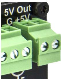
Il est également possible d'utiliser la sortie 5V pour alimenter un périphérique qui nécessite une tension d'alimentation plus basse.
